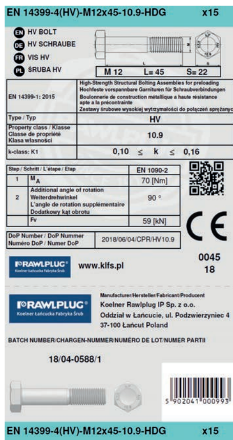
Rys. 11 Przykładowa etykieta charakteryzująca zestaw śrubowy dla klasy K1.
